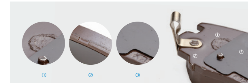
Рис. 4. Фрикционная пластина может расслоиться, плохо читаемая гравировка, неоригинальные колодки имеют неровные края
