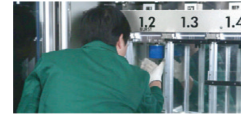
Рис. 1. Для масляных фильтров используют специальный тест на герметичность
