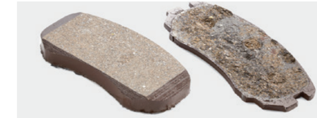
Рис. 2. Неоригинальные колодки выполнены по менее современным технологиям, они легче, имеют менее гладкую поверхность
