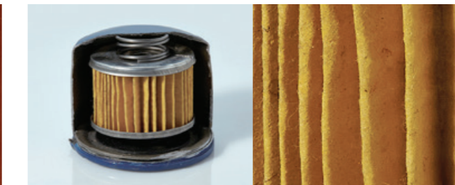
Рис. 6. Материал неоригинального фильтра неравномерно склеен с торцевыми пластинами фильтра, из-за дешевого материала фильтровальная бумага легче
