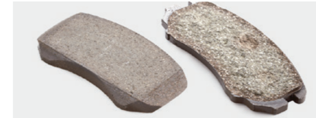
Рис. 1. Оригинальные накладки тормозных колодок спрессованы под высоким давлением, более тяжелые, с гладкой поверхностью, с четко выраженным цветом
